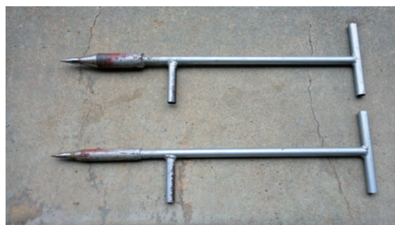
写真-6 コンテナ苗植栽用ディブル 宮城県苗組式 上：300cc用、下：150cc用
